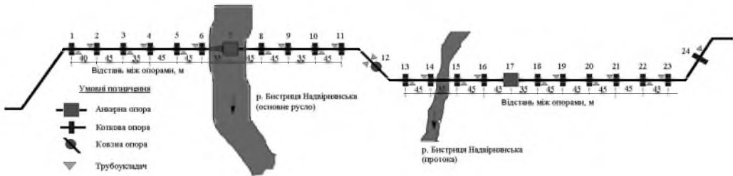
Рис. 1. Схема ремонтних робіт повітряного переходу. (Тут і на рис. 2 цифрами позначено номери опор.)
