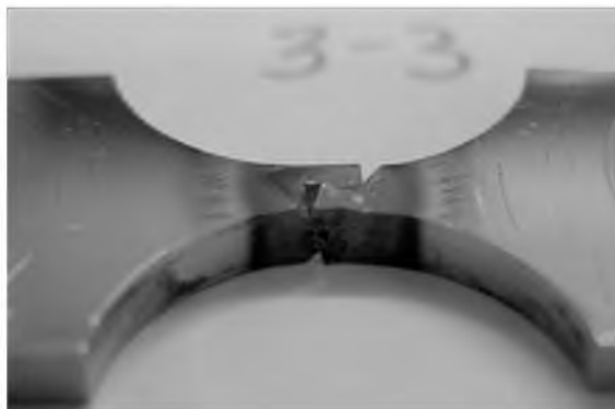
Рис. 6. Внешний вид разрушенного образца № 3-3 с ориентацией [011] после 1220 цикл.
