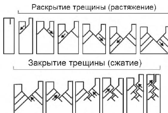
Рис. 2. Процессы сдвига в вершине усталостной трещины при активации двух систем скольжения [13].
