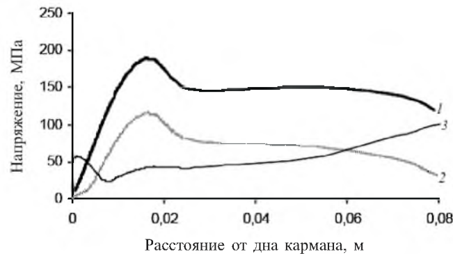
Рис. 6. Распределение остаточных окружных \sigma_\varphi напряжений на поверхности кармана со стороны патрубка (по результатам двумерных расчетов): 1 – “базовый” вариант ТО; 2 – вариант ТО с граничными условиями в виде конвекции в кармане; 3 – вариант ТО с дополнительным разогревом патрубка ПГ.
