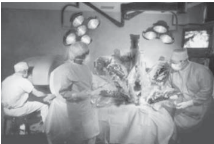
Рис. 7. Внешний вид операционной, в которой проводится робототехническое телевидеовмешательство (удаление желчного пузыря). Слева — консоль хирурга, справа — операционный стол с манипуляторами
