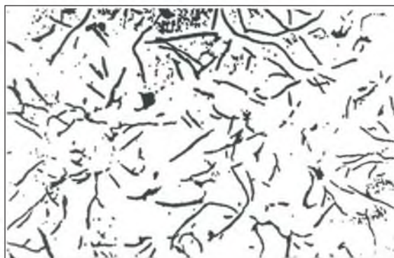
Рис. 1. Микроструктура серого чугуна (×100).
