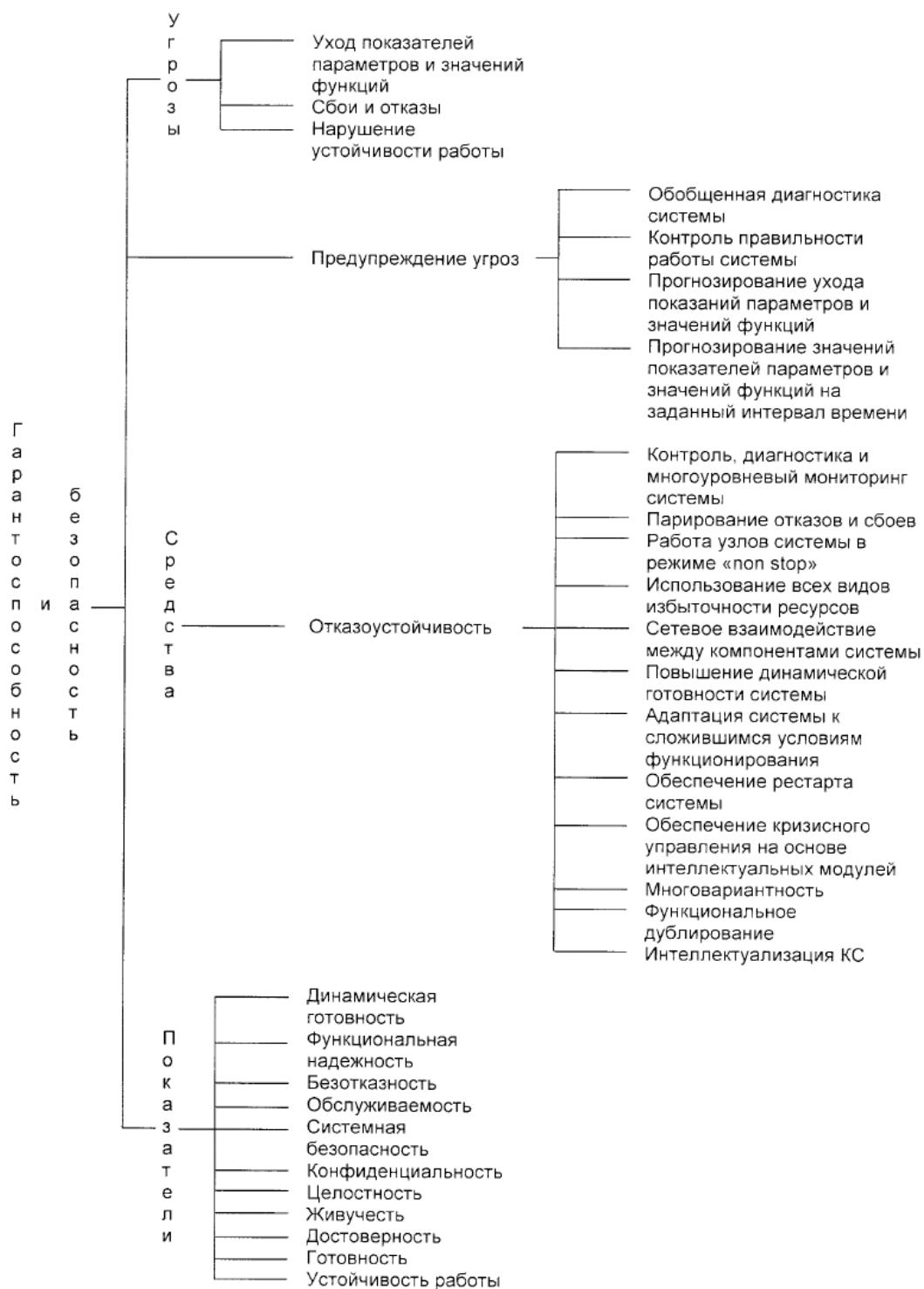
Рис. 3. Дерево гарантоспособности и безопасности
