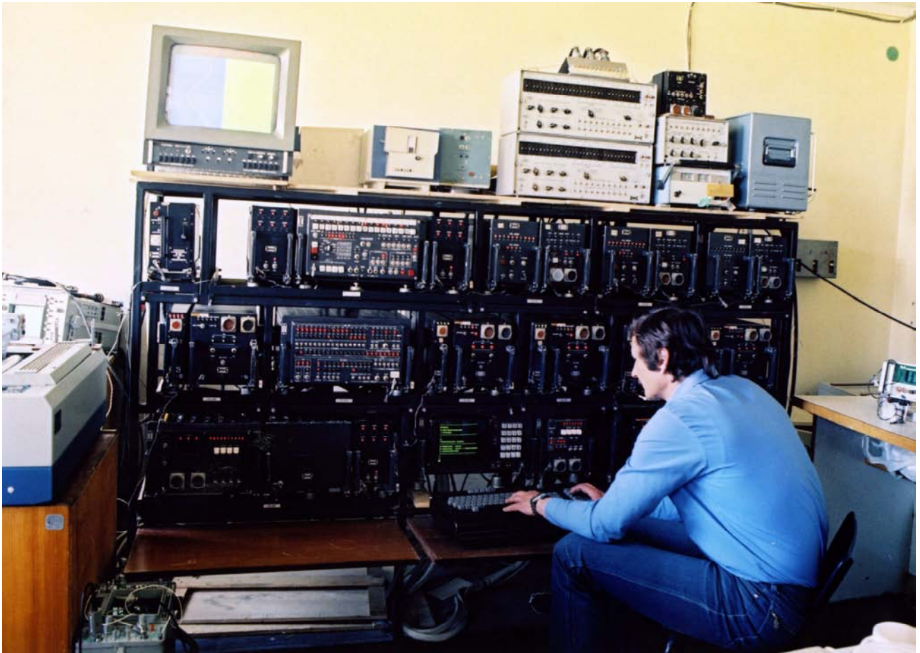
Рис. 9. Бортовий багатоканальний ІВК БАРК перед установленням на борт екраноплана "Лунь"
