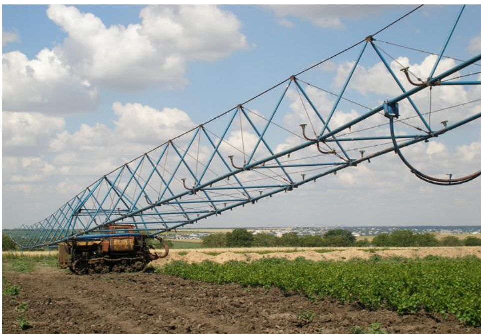
РИС. 2. Машина для зрошення виноградників ДП ДГ «Таїровське»
