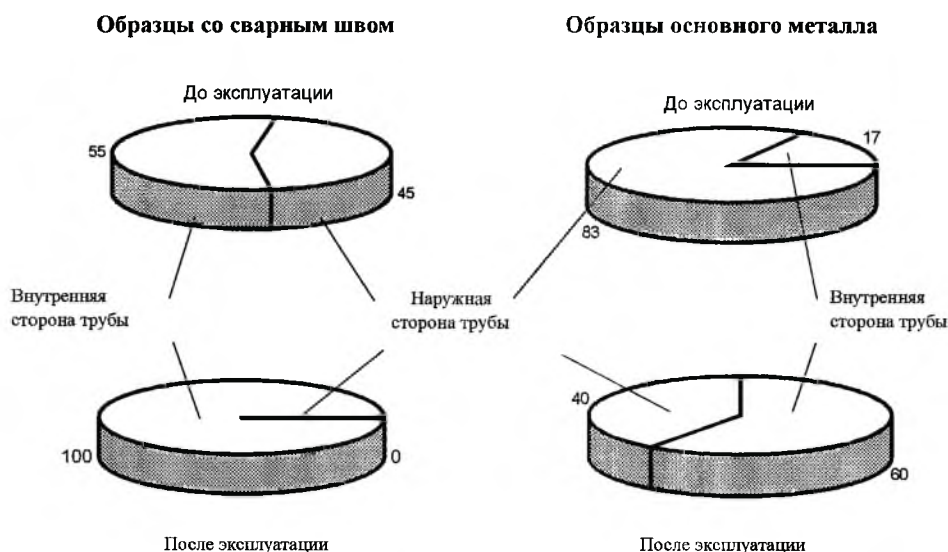
Рис. 8. Распределение количества усталостных трещин на наружной и внутренней поверхности образцов трубной стали до и после эксплуатации. (Цифры – количество трещин, %.)
