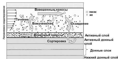
Рис. 1. Схематическое представление процессов переноса наносов в лагранжевой модели [8]
