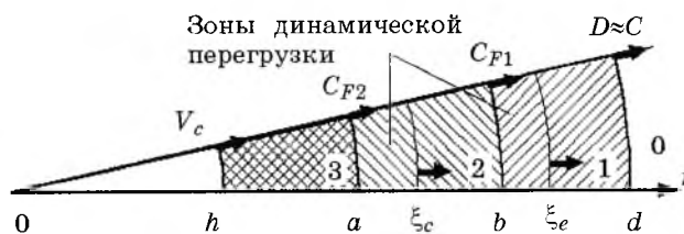
Рис. 1. Схема областей с различным состоянием материала при расширении сферической полости в хрупком материале.
