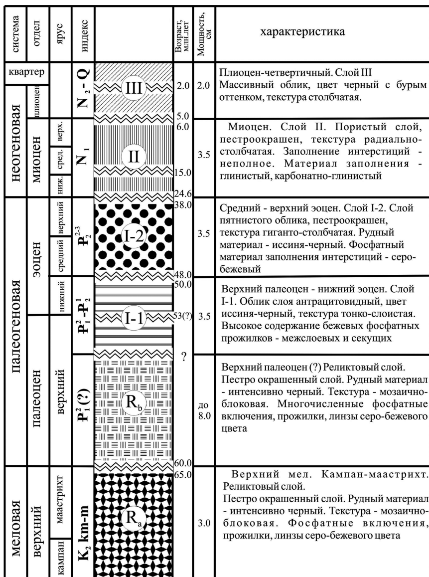
Рис. 2. Разрез железомарганцевых корок Магеллановых гор [13]
