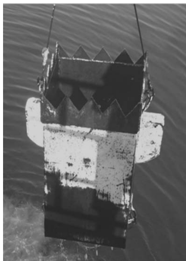
Рис. 1. Подъем заполненной драги на палубу судна
