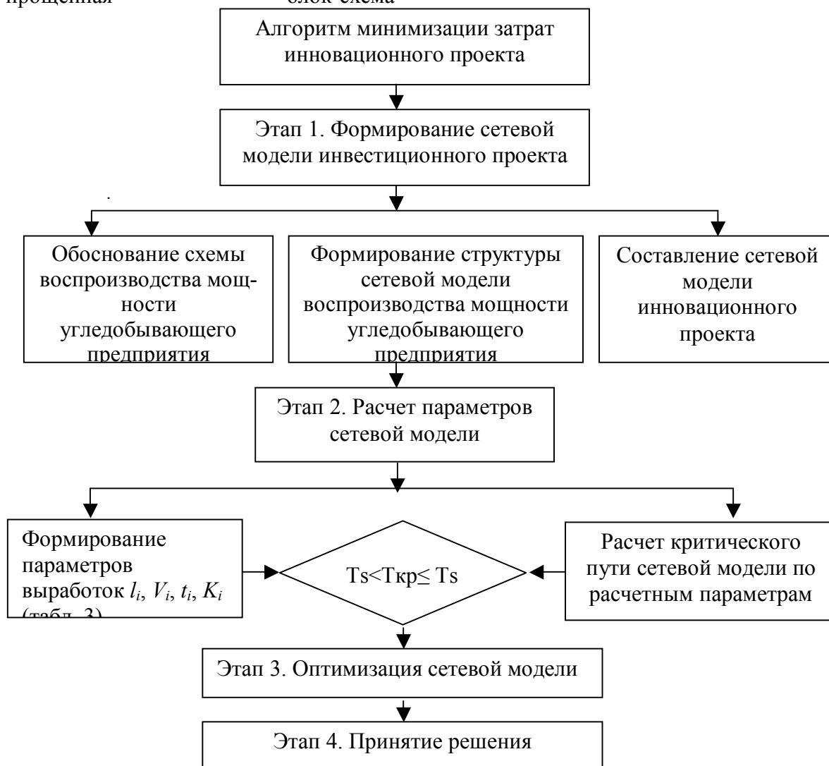
Рис. 3. Механизм оптимизации инновационного проекта
