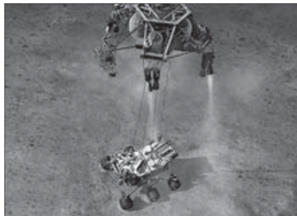
Художнє зображення спуску марсохода «Curiosity» за допомогою технології «небесний кран»
