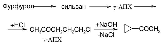
Процесс получения МЦПК по этой технологической схеме отличался низкими выходами целевых продуктов, отсутствием эффективных и доступных катализаторов. Принятая технология в ряде случаев затрудняла создание реакционных аппаратов большой единичной мощности, наконец, самое важное, – синтез МЦПК базировался на использовании дефицитного сырья – фурфурола.
