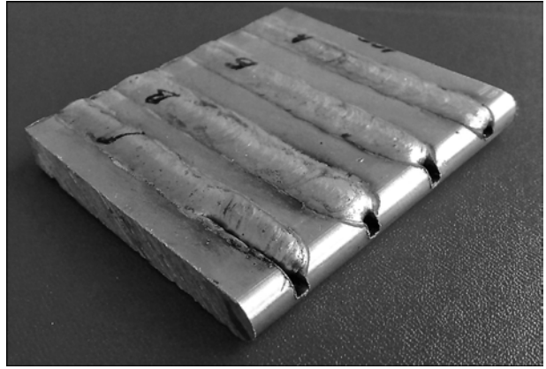
Рис. 3. Внешний вид валиков, наплавленных в канавках на образце из сплава АМг6 ( \delta = 10 мм) с применением проволоки СвАК5 ( d = 1,2 мм): слева направо — дуговая наплавка при I = 210 А, U = 23 В и I = 250 А, U = 25 В, две канавки — гибридная наплавка
