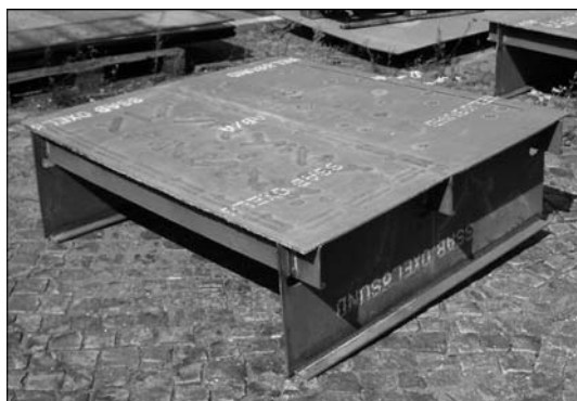
Рис. 1. Образец судостроительной панели
