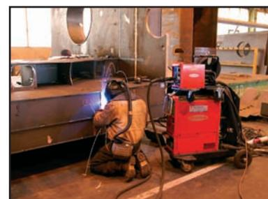
Компания «Liebherr» из Сазерленда, Великобритания, предпочла современный импульсно-дуговой способ сварки с использованием цифровой системы TransPlus Synergic 5000
