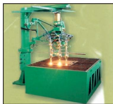
Машина может успешно использоваться для вырезки готовых деталей типа фланцев, косынок, планок и т. д.
