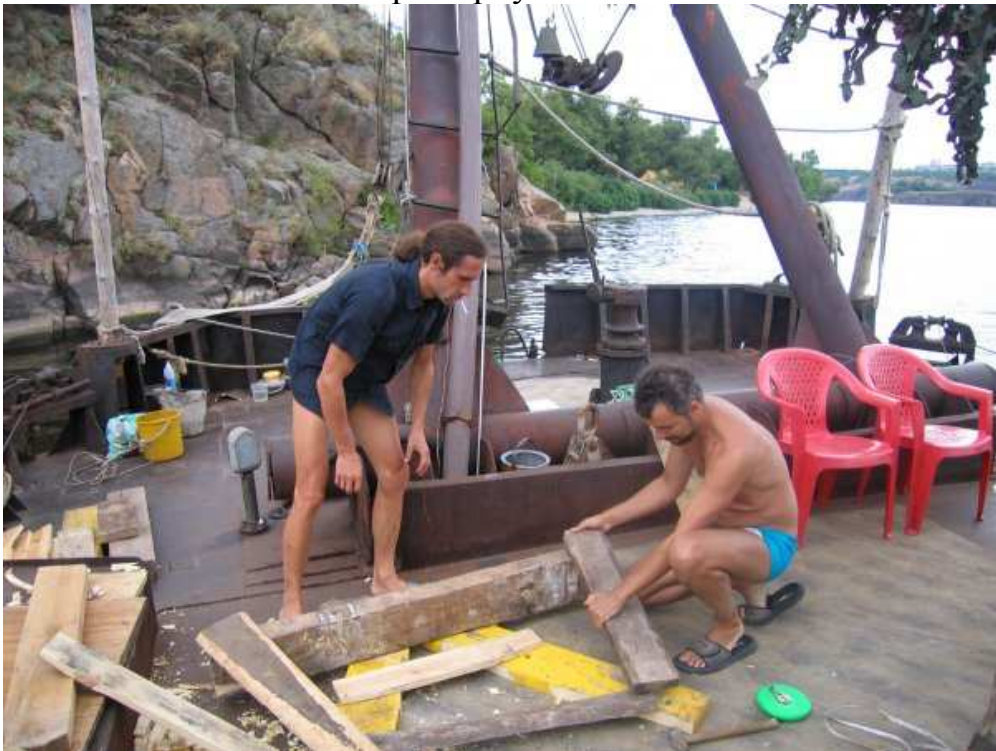
Фото 22. Изготовление элементов конструкции для подъема кормы судна.
