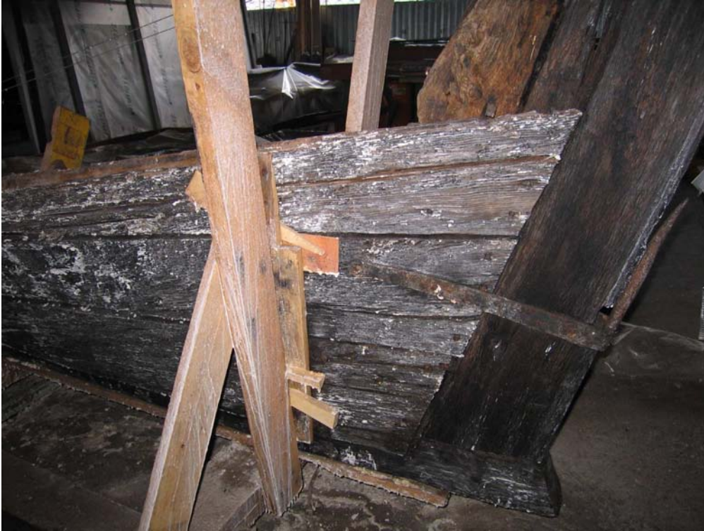
Фото 27. Кормовая часть судна в процессе консервации.
