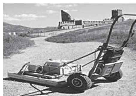
Рис. 5. Сканувальний георадар для виявлення в ґрунті на глибинах до 20–30 м шарів, порожнин та інших утворень природного або антропогенного походження.
