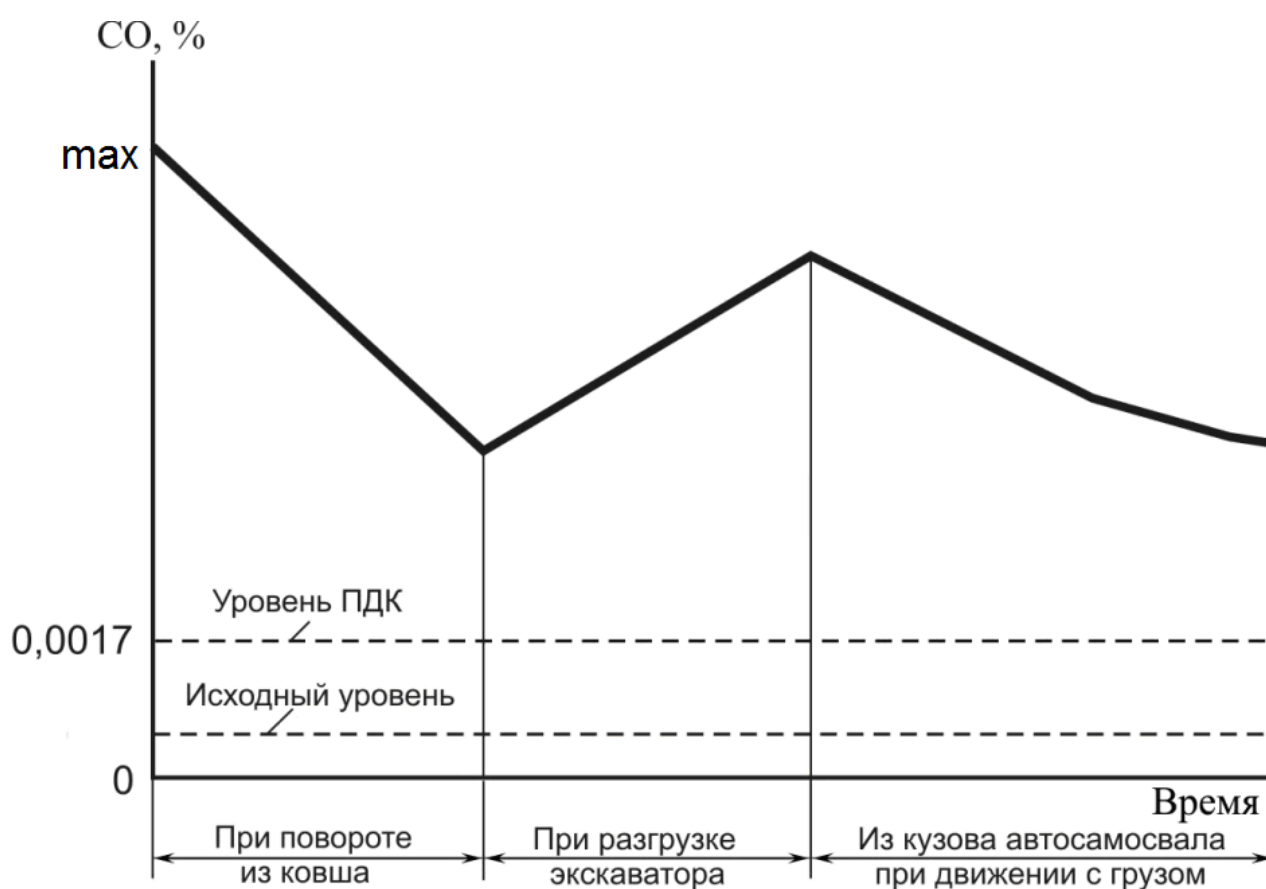
Рис. 2 - Характер газовыделения из ковша экскаватора и кузова автосамосвала.
