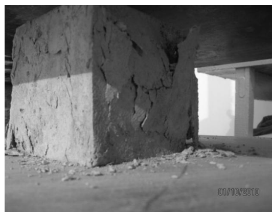
Рис.1 - Форма разрушения образцов твердеющей закладки
