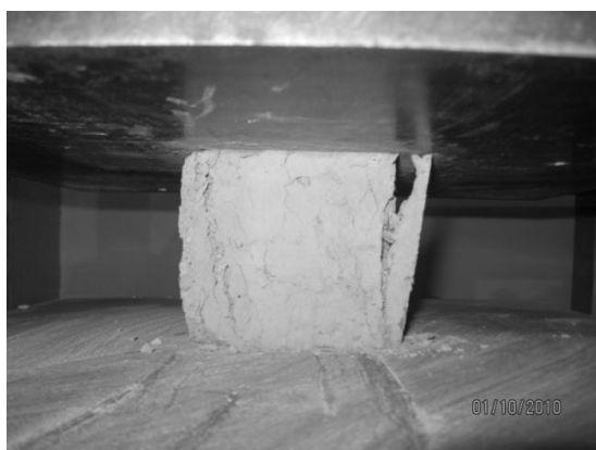
Рис.1 - Форма разрушения образцов твердеющей закладки
