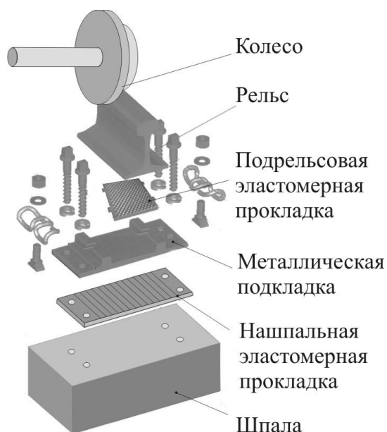
Рис. 1 – Основная схема расположения эластомерных прокладок в системе взаимодействия подвижного состава и рельсового пути
