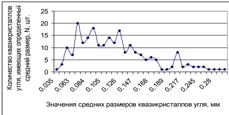
Рис. 4 – График распределения квазикристаллов угля, выделенных в пробах, отобранных на шахте «Павлоградская», по средним размерам (зона лежачего крыла сброса)
