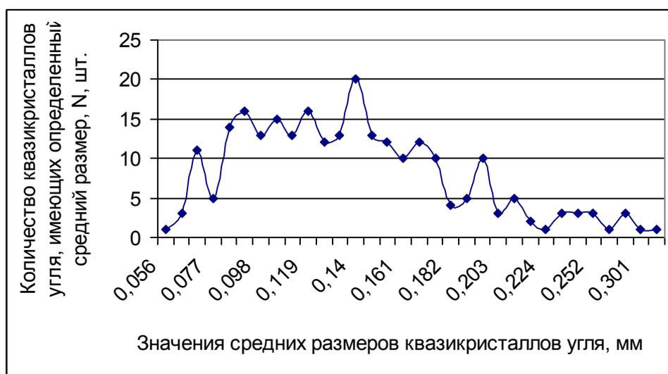
Рис. 8 – График распределения квазикристаллов угля, выделенных в пробах, отобранных на шахте «Павлоградская», по средним размерам (зона висячего крыла сброса)
