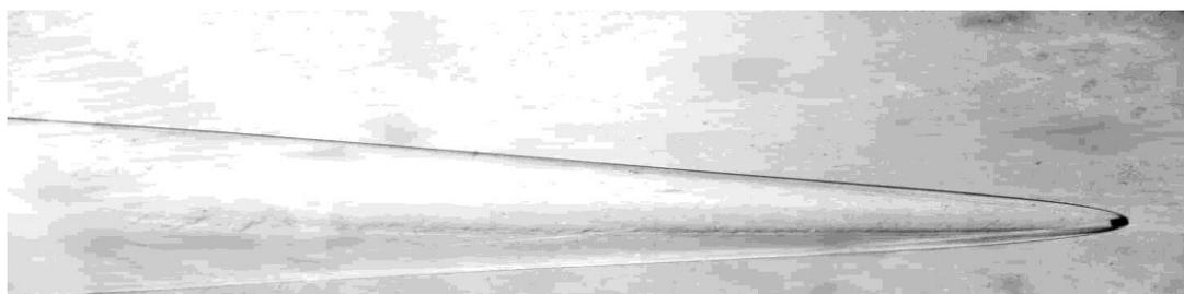
Рис. 3 — Полет 2 мм ударника со скоростью 5.7 км/с в атмосферном воздухе
