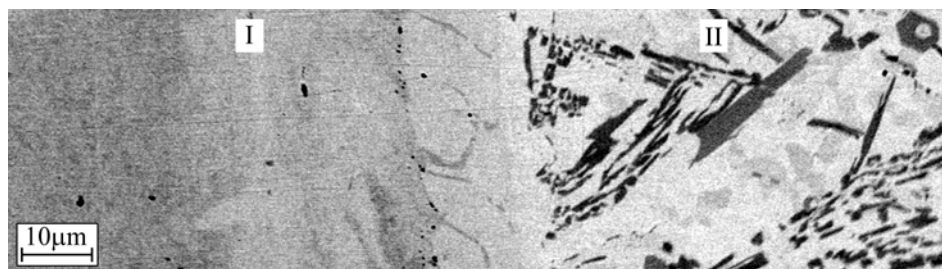
Рис. 5. Структура матеріалу шибера з наплавкою після витримки в розчині NACE (200 h): I – сталь 30XMA; II – наплавка.
