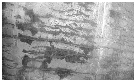
Рис. 5. Дефект поверхности отливки "пригар"
