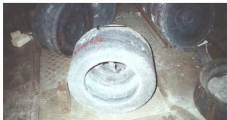
Рис. 1. Электрошлаковые заготовки из стали 20Х2Н4А
