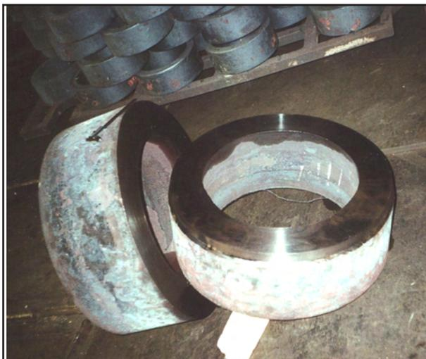
Рис. 5. Электрошлаковые заготовки после прокатки и подготовки к ультразвуковому контролю
