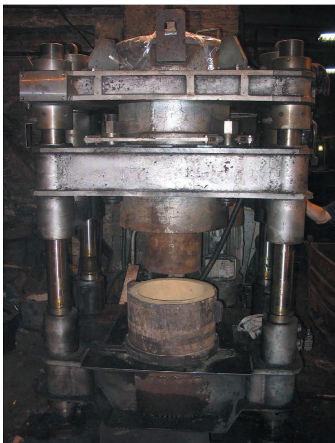
Рис. 1. Установка литья выжиманием с кристаллизацией под избыточным регулируемым давлением
