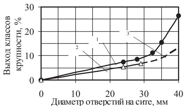
Рис. 1. Выход отсева кокса крупностью до 40 мм при обработке коксов Донецкого региона на вибрационном грохоте: 1 – среднее значение по Авдеевскому, Енакиевскому, Макеевскому и Ясиновскому КХЗ; 2 – фактический выход коксового отсева из кокса в условиях ОАО «ЕМЗ» при диаметре отверстий на ситах кокса 24 и 28 мм; 3 – ожидаемый выход коксового отсева из кокса при диаметре отверстий на ситах кокса в диапазоне 28-40 мм
