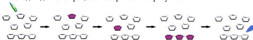
Рис. 1. Механизм передачи возбуждения в молекулах сцинтиллирующего коктейля
