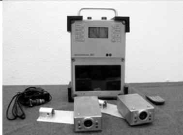
Рис.1. Блок оператора и два УВИП диагностического зонда ДЗ-1
