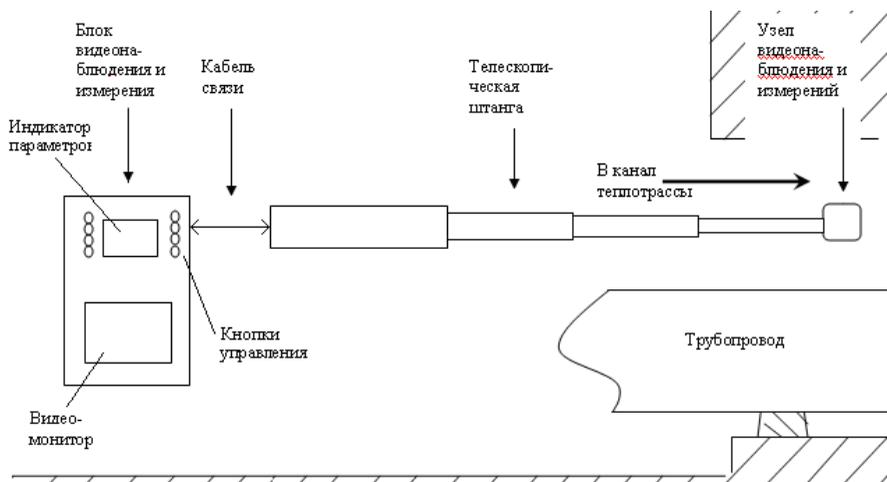
Рис.3. Схема применения диагностического зонда ДЗ-1 для обследования канала теплоотрамы из теплокамеры
