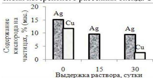
Рис. 4. Влияние выдержки коллоидных растворов на содержание кислорода на поверхности наночастиц меди и серебра.
