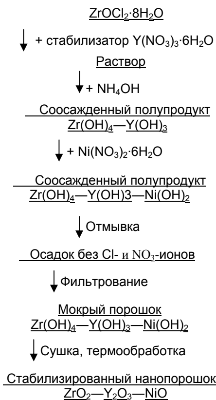
Рис. 1. Технологическая схема процесса получения порошка \text{ZrO}_2 - \text{Y}_2\text{O}_3 - \text{NiO} .
