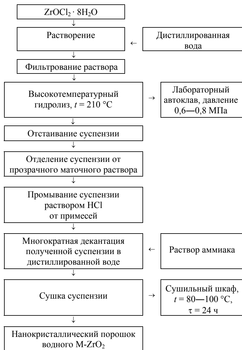
Рис. 1. Схема получения нанокристаллического порошка водного M-ZrO 2 гидротермальным разложением ZrOCl 2 в кислой среде.
