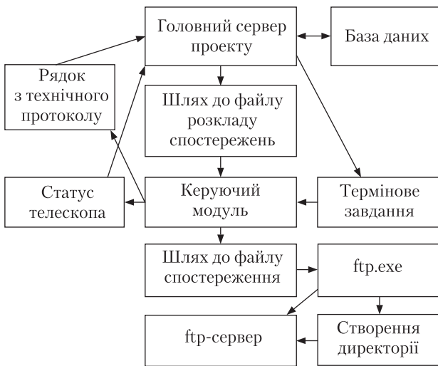
Рис. 5. Схема взаємодії модуля netd з іншими програмними модулями
