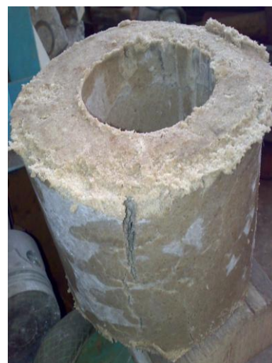
Рис. 3. Експериментальний зразок КГЕ при 15%-ої концентрації желатину після розтеплення на повітрі та випробувань
