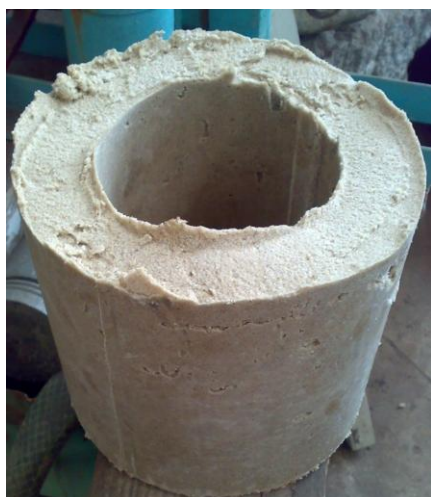
Рис. 2. Експериментальний зразок КГЕ при 15%-ої концентрації желатину до випробувань
