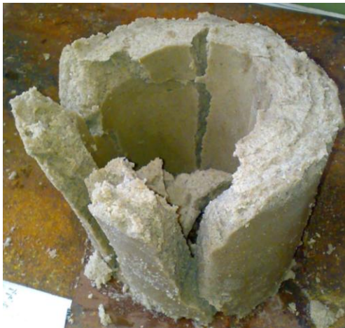
Рис. 5. Зруйнований експериментальний зразок КГЕ при 15%-ній концентрації желатину після 30 хв. витримки на повітрі при температурі 17^{\circ}\text{C} з послідувочою 30 хв. витримкою у воді при початковій температурі 17^{\circ}\text{C}
