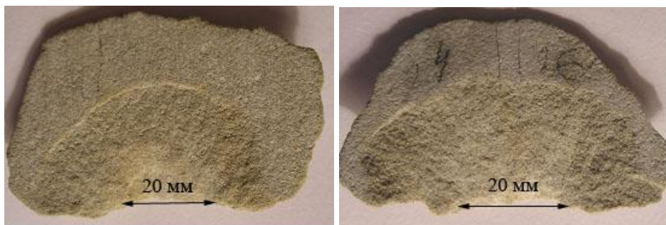
Рис. 4. Общий вид фрагментов шлама, полученных при резании песчаника Тербовлянского месторождения на глубину h_{рез} = 6 мм и шаге резания H = 60 мм (приведенный размер 20мм соответствует области контакта твердосплавной вставки с блоком горной породы)
