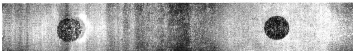
Рис. 3. Дебаеграмма покрытий \text{Si}_3\text{N}_4 .
