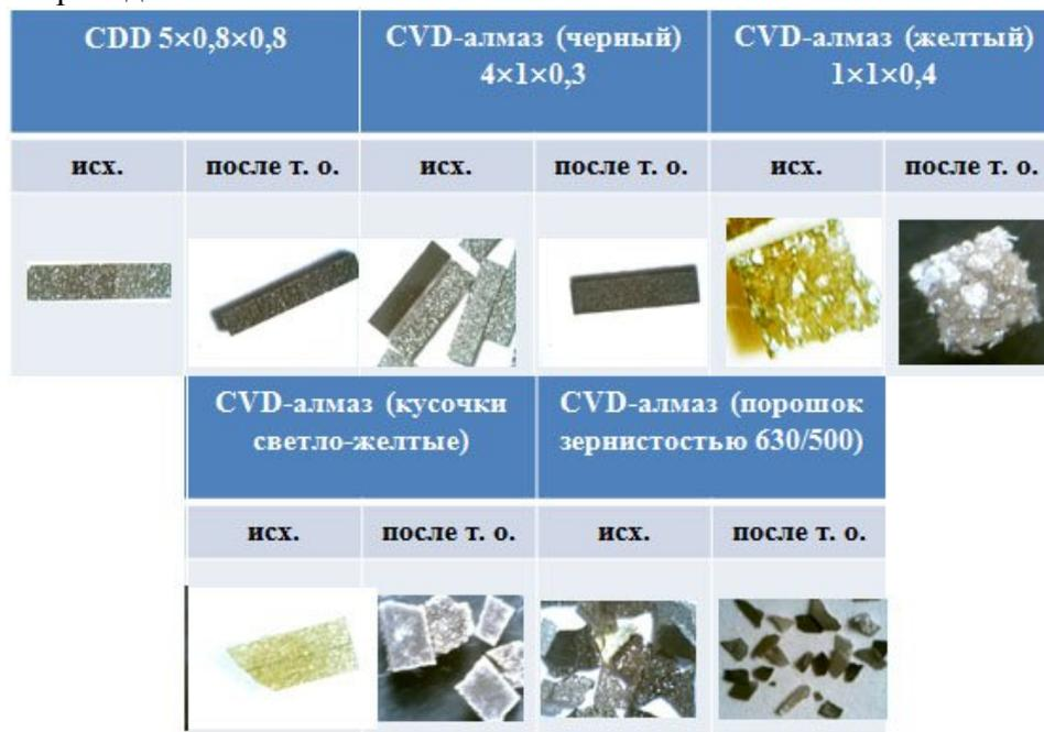
Рис. 5. Изменение внешнего вида различных образцов CVD-алмаза после термической обработки в токе аргона ( $T = 1150$  °С;  $\tau = 600$  с)
