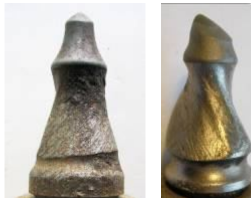
Рис. 2. Вигляд різців з дуже зношеною державкою
