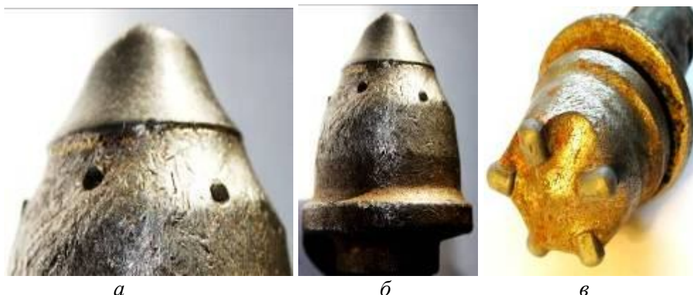
Рис. 5. Характер зношення експериментальних різців: а, б – із вставками полікристалічних алмазів; в – із твердосплавними штирями
