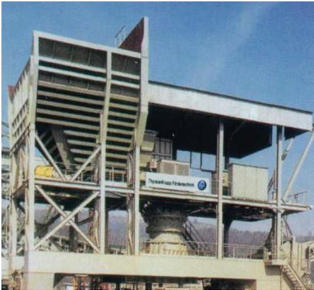
Рис.4. Полустационарная дробильная установка Производительностью 5000 т/ч
