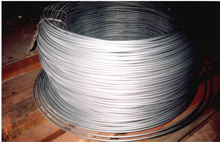
Рис.7. Внешний вид арматурного проката №14 из стали 35ГСм, термомеханически упрочненного на класс А500С.
