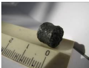
Рис. 1 Общий вид ПС алмаза, предназначенного для производства порошков алмаза марок АС4–АС10 и микропорошков
