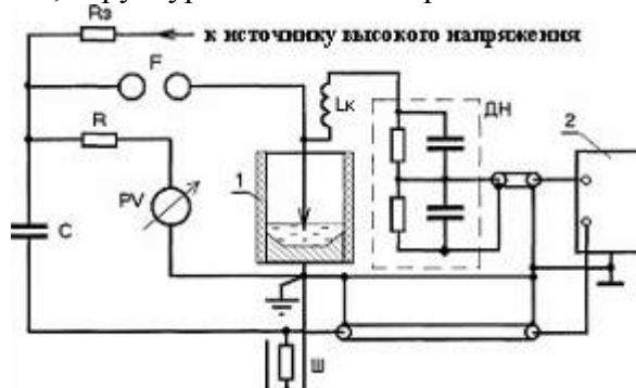
Рис. 3. Структурная схема экспериментального стенда: C – конденсатор накопителя; R_z – балластный резистор; R – резистор; PV – киловольтметр; F – воздушный разрядник; \text{Ш} – коаксиальный шунт; L_k – катушка компенсации; \text{ДН} – делитель напряжения; 1 – разрядная камера; 2 – осциллограф
