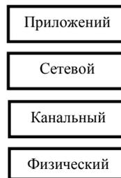
Рис. 2. Стек сетевых протоколов сенсорной сети
