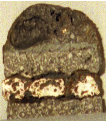
Рис.1. Сечение зоны взаимодействия агломерата осн. 1.15 ед. с исходным футеровочным материалом
