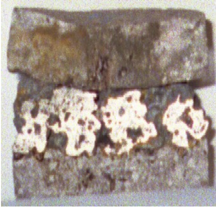
Рис.3. Сечение зоны взаимодействия агломерата осн. 1.15 ед с футеровочным материалом из охлаждаемой зоны
