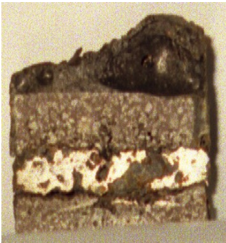
Рис.5. Сечение зоны взаимодействия смеси (90% агломерата осн. 1.15 ед + 10% шлак обогащенный) с исходным футеровочным материалом
