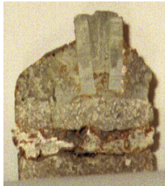
Рис.4. Сечение зоны взаимодействия смеси (80% агломерата осн. 1.15 ед + 20% шлак обогащенный) с исходным футеровочным материалом
