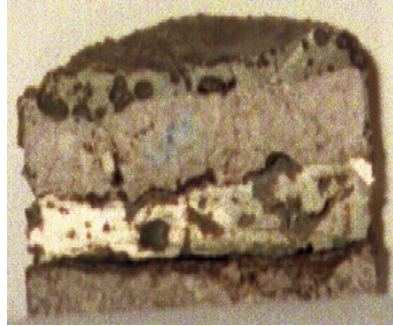
Рис.3. Сечение зоны взаимодействия агломерата осн. 1.15 ед с футеровочным материалом из охлаждаемой зоны
