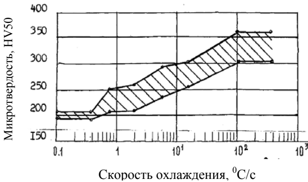
Рис.3 – Микротвердость dilatометрических образцов, охлажденных после предварительной аустенизации при 950^{\circ}\text{C} в интервале скоростей 0,1-350^{\circ}\text{C}/\text{c}
